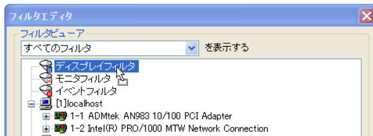
図 6-18: ディスプレイフィルタの条件をドラッグアンドドロップで生成する
